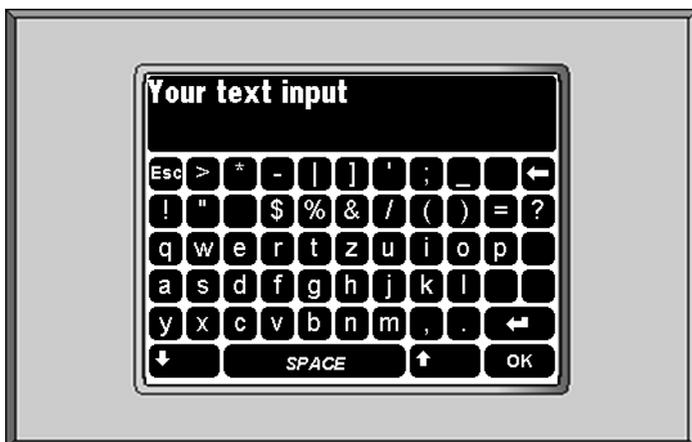
Jeder Tastendruck auf die alphanumerische Tastatur wird in den oberen beiden Textzeilen angezeigt. Einige Tasten haben Sonderfunktionen:
