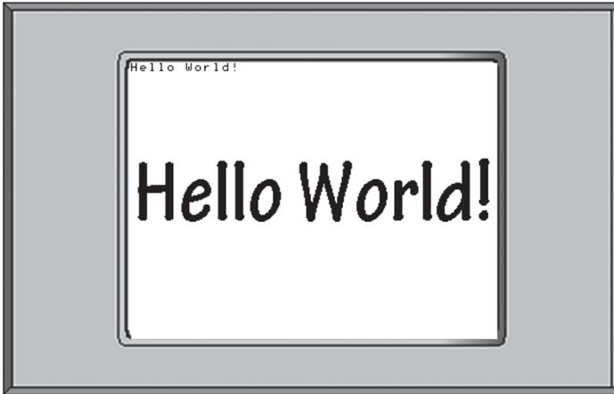
Was passiert im Programm? Zunächst werden einige Voreinstellungen gemacht. Diese sind typisch für den TP1000 Touchpanel Computer und sollten so oder in ähnlicher Form in jedem Programm vorkommen. Dies betrifft vor allem die Definition der Pins (unter „LCD pins“) und die Initialisierung des LCD (unter „initialize LCD 1/4 VGA“).
