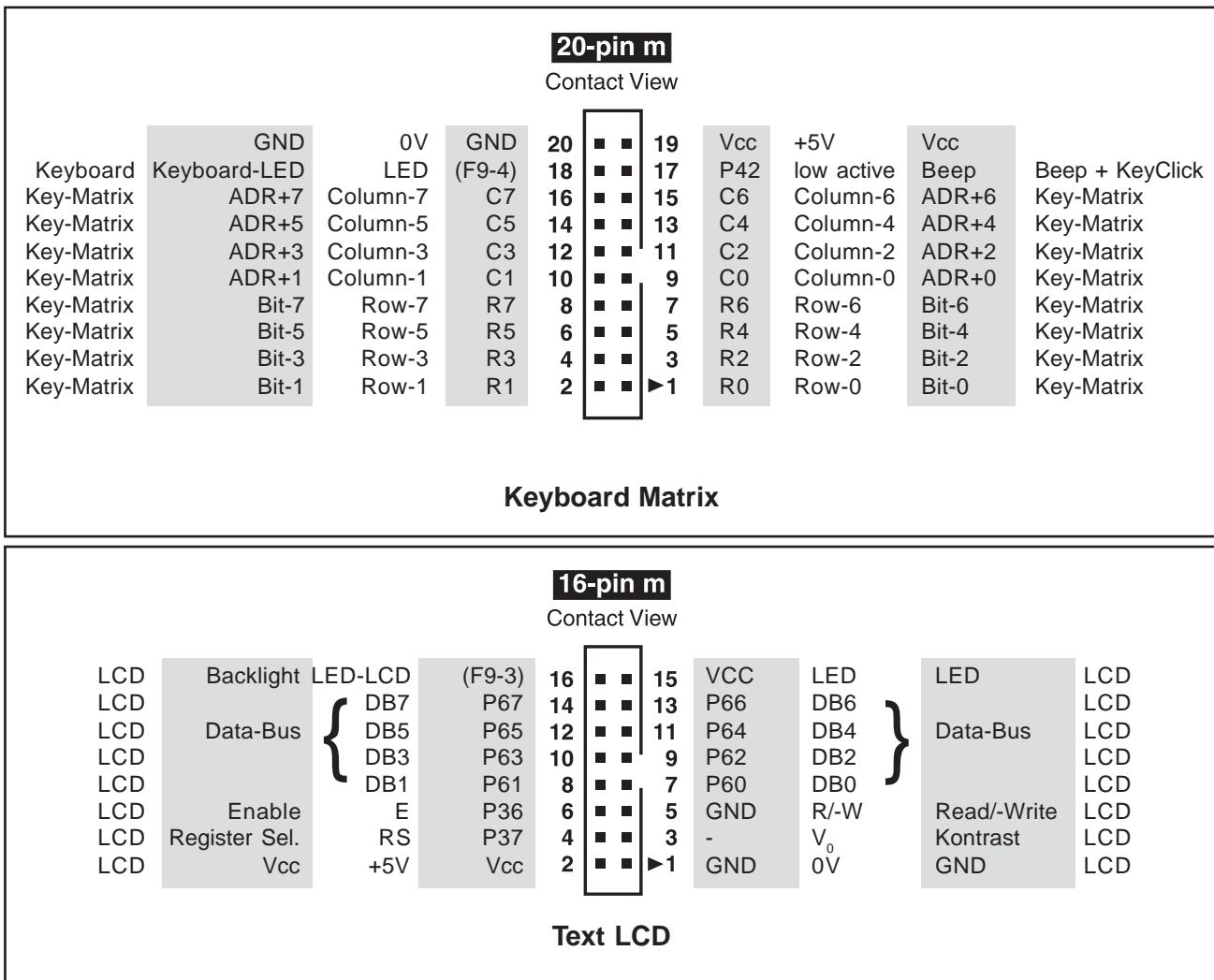
**TEC2200** ist eine auf eine 21TE 3HE (106,3mm x 128,4mm x ca.15mm) 2,5mm starke Aluminiumfrontplatte mit Text- LCD Display für 4x 20 Zeichen und 24 Tasten. Der Tastenabstand beträgt in horizontal 12,5mm und vertikal 11mm.
