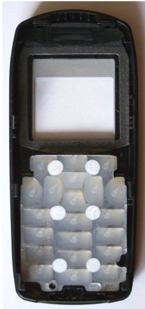
Bild 5 der vordere Deckel wird entfernt
