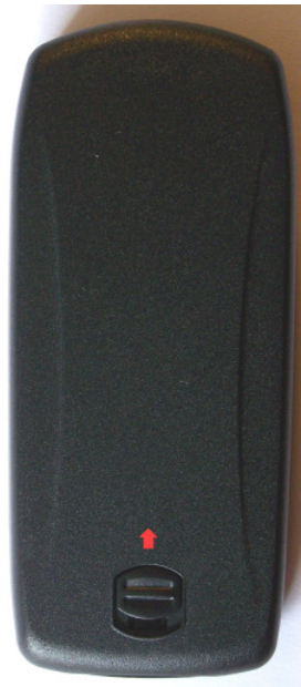
Bild 2 Rückseitendeckel öffnen
