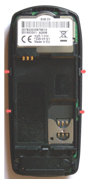
Bild 4 Mit 4 Snap-In-Klinken wird das komplette Chassis festgehalten
