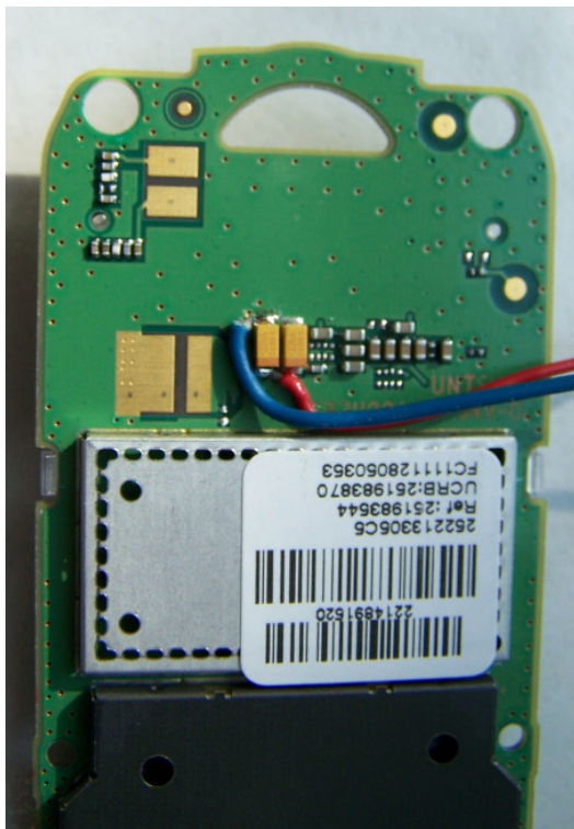
Bild 13 Anzapfung des Handy-Akkus
