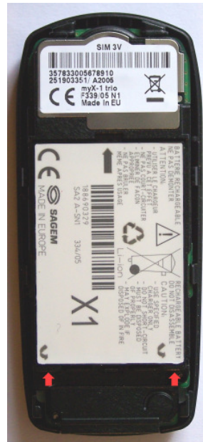
Bild 3 Akku und SIM-Karte entfernen
