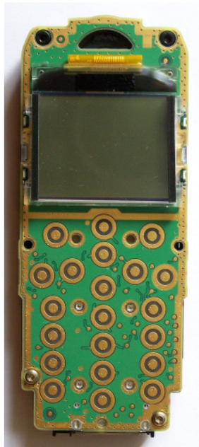
Bild 9 Display nun wieder zu-klappen und einrasten
